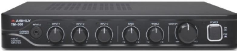
Ashly TM-360 将混音台和60W功放结合为一体，主要应用于背景音乐及分区广播。输入1采用平衡方式的Euroblock接口，可连接话筒输入（可幻象供电）或线路输入。输入2和输入3提供了平衡方式的Euroblock接口和双RCA接口（可同时使用），可连接线路输入。输入2还特别在前面板设置了1个立体声“mini-jack”接口（使用此接口时将旁路设备背板的RCA接口）。3组输入都有独立的增益控制、信号电平指示LED和前面板的音量控制。
